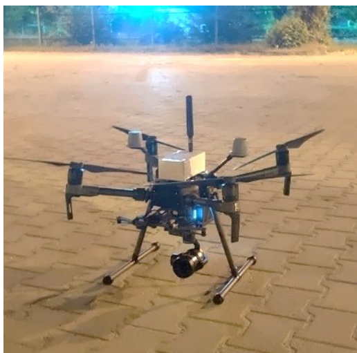
Rys. 2. Autorskie urządzenie pomiarowe zamontowane na pokładzie wielowirnikowca firmy DJI modelu Matrice 201 RTK
